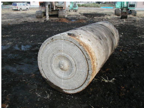
掘り起こした改良体の先端部状況
