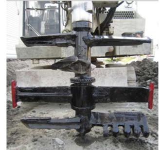
写真-1 Dコラム工法攪拌翼
