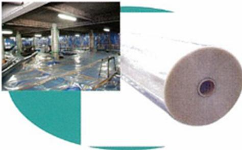
PETシート: 丈夫で破れにくい、高い負圧状態に保つことで外部への石綿流出を防止します。
