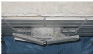
写真2 ウェブフォームによるタイル面の連結効果
