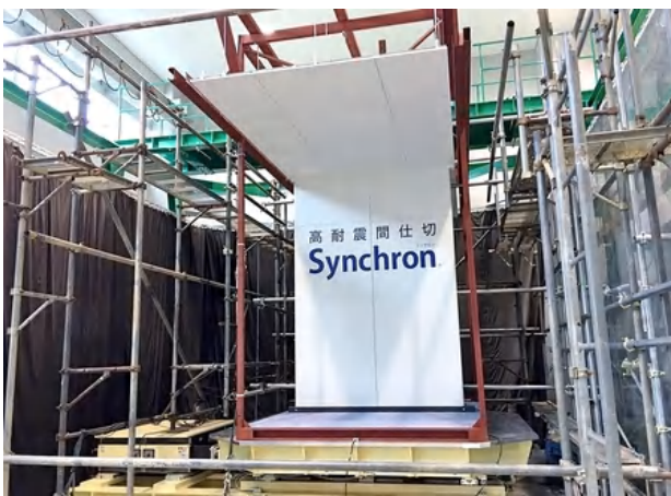
写真：振動台による耐震性検証の実験風景
